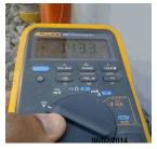
8 Ubicación: Samsung salida VCC-CSE (volts): -1.26 VCA-CSE (volts): 9.60 Observaciones: Valor normal.
