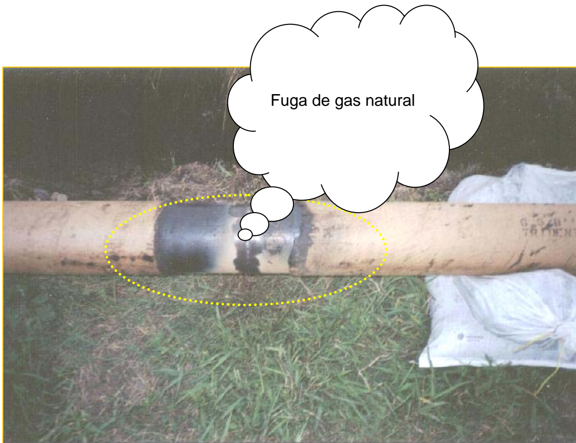
Segmento de ducto de acero, que resultaría golpeado por una pala mecánica en el Derecho de Vía del camino industrial frente a la Estación de Medición y Regulación de Proteinol , en la Zona Industrial de Apaseo El Grande .
